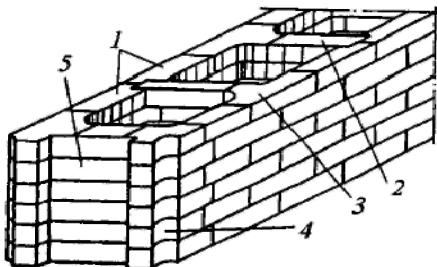
1 – ложковый стеновой кирпич; 2 – бруск (распорочный кирпич); 3 – гитарковый стеноj кирпич; 4 – заплечик головки; 5 – ниша для изоляции головки фасада
