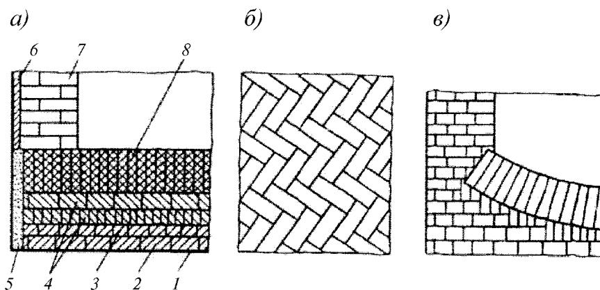
*a – многослойная подина; б – «в елочку»; в – обратным сводом; 1 – кожух; 2 – легковесный кирпич на ребро; 3 – огнеупорный кирпич на плашку; 4 – огнеупорный кирпич на ребро; 5 – температурный шов; 6 – асбест листовой; 7 – стена; 8 – огнеупорный кирпич на торец*
