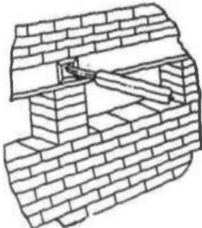
Рисунок 56 – Временное крепление замка футеровки маяками из кирпича
