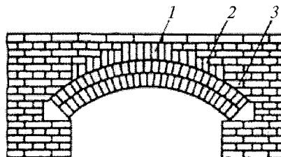
*1 – на торец; 2 – на ребро; 3 – на плашку*
