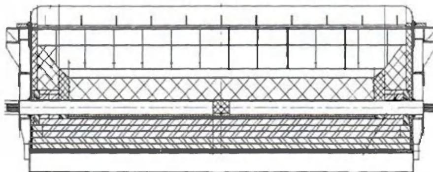
Рисунок Ж.11 – Схема катодной футеровки (поперечный разрез)
