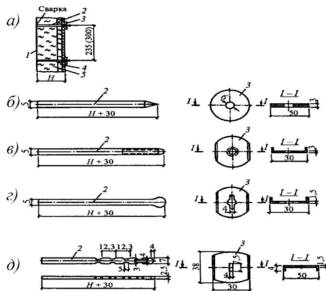
а – схема анкерного крепления; б – анкер с привариваемой шайбой; в – с винтовой шайбой; г – с поворотной шайбой; д – с многопозиционной шайбой; 1 – кожух; 2 – анкер; 3 – шайба; 4, 5 – слои волокнистой футеровки
