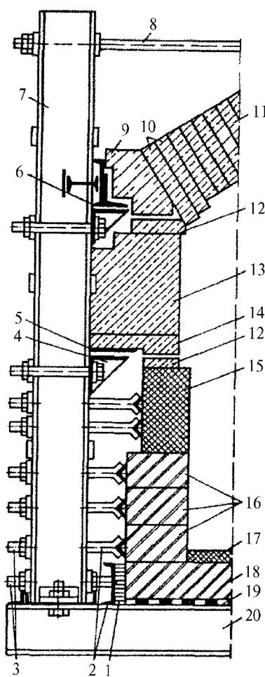
1 – разделка шамотным кирпичом; 2 – пружинные устройства; 3 – прижимные болты; 4 – кронштейн; 5 – лафет; 6 – подпятая балка; 7 – колонна; 8 – тяга; 9 – пяты; 10 – защитные изделия пят; 11 – главный свод; 12 – подклиник; 13 – подвесная стена; 14 – «зуб»; 15, 16 – блоки окружки; 17 – плитка; 18 – дно; 19 – опорные полосы; 20 – поперечная балка
