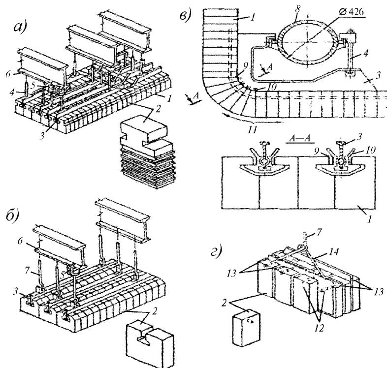
*a – из рифленого кирпича; б – из гладкого кирпича; в – набор криволинейной части; г – магнезитохромитовый; 1 – вкладыш; 2 – кирпич; 3 – жароупорные балочки; 4 – болт; 5 – скоба; 6 – балка; 7 – тяга; 8 – водоохлаждаемая балка; 9 – приливы; 10 – литая деталь; 11 – направление набора свода; 12 – стальной стержень; 13 – стальная прокладка; 14 – подвески*
