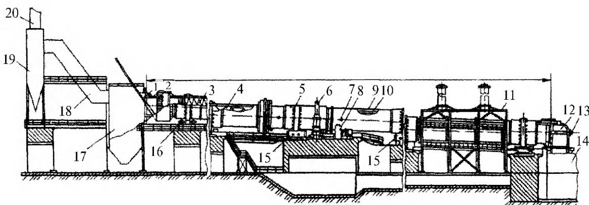
1 – течка для подачи шлама; 2 – фильтр-подогреватель; 3 – цепная завеса; 4 – теплообменник; 5 – бандаж; 6 – венцовая шестерня; 7 – пробоотборные лючки; 8 – привод печи; 9 – корпус печи; 10 – огнеупорная футеровка; 11 – устройство для охлаждения корпуса печи в зоне спекания; 12 – головка печи; 13 – горелка; 14 – холодильник; 15, 16 – роликовые опоры; 17 – пылевая камера; 18, 20 – газоходы; 19 – фильтр
