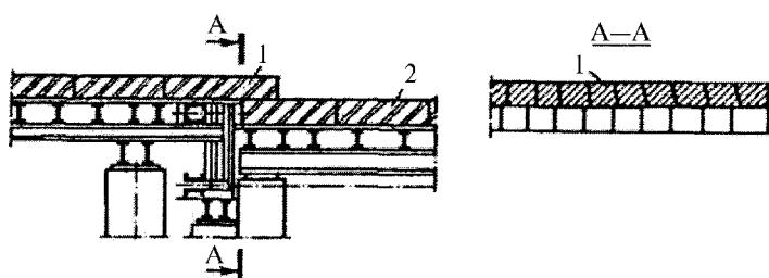
1 – крайний (перекрывающий) ряд дна студочной части; 2 – перекрываемый ряд дна варочной части
