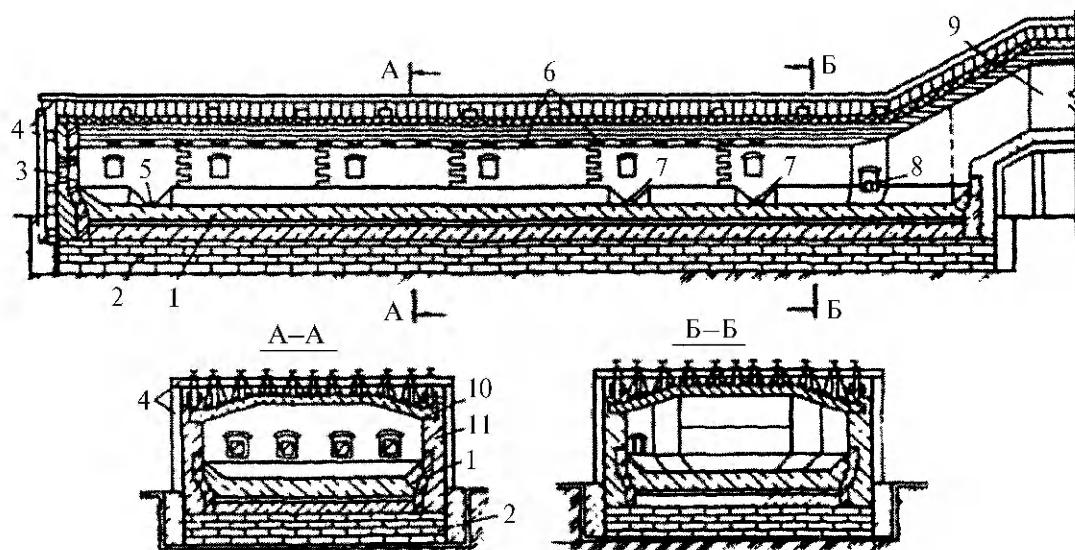
1 – лещадь; 2 – фундамент; 3 – окно для горелки (форсунки); 4 – металлический каркас печи; 5 – запасной шпур; 6 – загрузочные отверстия; 7 – шпуры для выпуска штейна; 8 – шлаковое окно; 9 – газоход (аптайк); 10 – свод; 11 – стень
