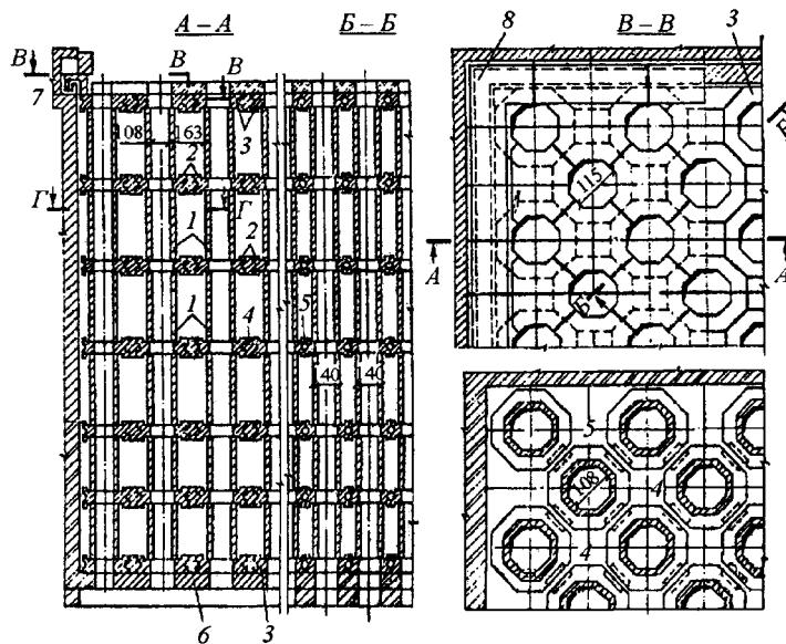
1 – керамические трубы; 2 – промежуточные звёздочки; 3 – нижние и верхние звёздочки; 4 – керамические вставки; 5 – уплотнительные цилиндры; 6 – нижние опорные изделия; 7 – песочный затвор; 8 – перекрывающие плиты
