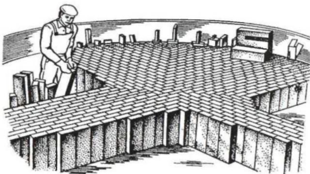
Рисунок 38 – Кладка днища конвертера
