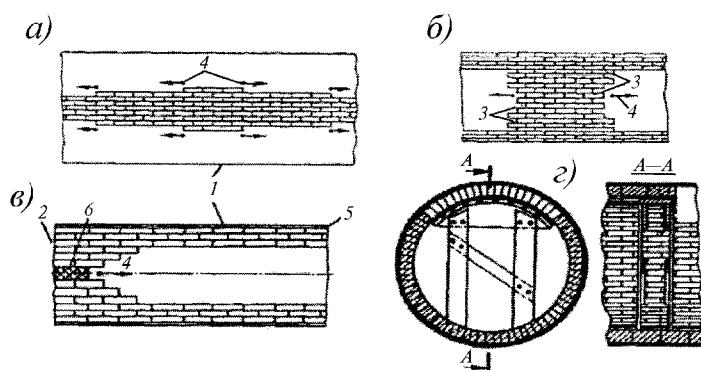
*a – убегающей штрабой от центра захватки; б, в – забивка замка штрабой (без опалубки); г – забивка с опалубкой; 1 – кожух; 2 – торец; 3 – штраба; 4 – огнеупорщики; 5 – коалиновый картон; 6 – замок (стрелками показано направление кладки)*
