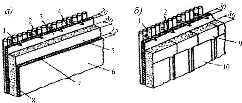
*a – с наружной обмазкой; б – с облицовочным листом; 1 – трубы экрана; 2 – анкерные штыри; 3 — жаростойкий бетон на сетке; 4 – слой крафт-бумаги; 5 – слой стеклоткани; 6 – поверхность обмазки; 7 – обмазка; 8 – минераловатные маты; 9 – минераловатные плиты; 10 – облицовочный лист*
