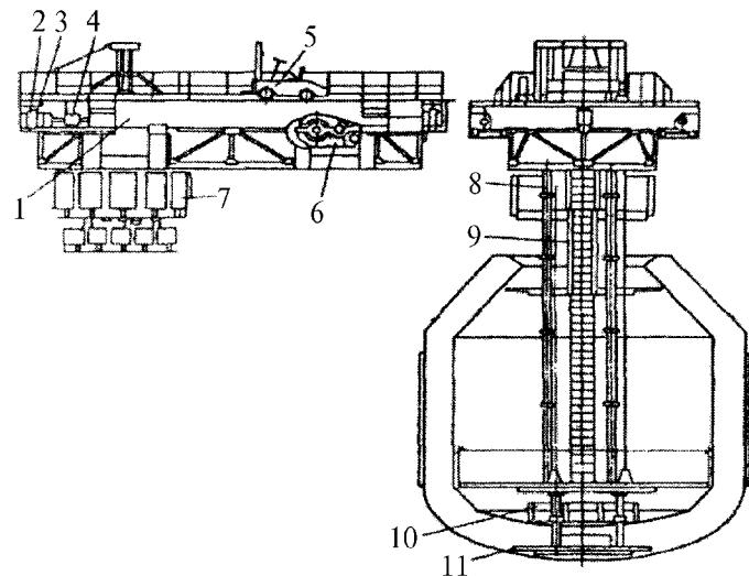
1 – мост крана; 2 – механизм передвижения; 3 – редуктор; 4 – подъемник материалов; 5 – погрузчик; 6 – лебедка; 7 – откидные помости; 8 – телескопические направляющие; 9 – лестница; 10 – рабочая площадка; 11 – нижняя площадка
