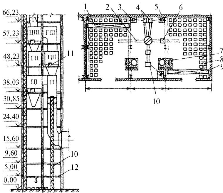
1 – кран-балка; 2 – узкоколейный путь; 3, 5 – лебедки; 4, 10 – шахтные подъемники; 6 – тележка; 7 – растворный узел; 8 – поддоны с кирпичом; 9 – кран-балка; 11 – проем для подачи огнеупоров; 12 – перекрытие; Ц-I–Ц-III – циклоны; Г-I–Г-IV – газоходы
