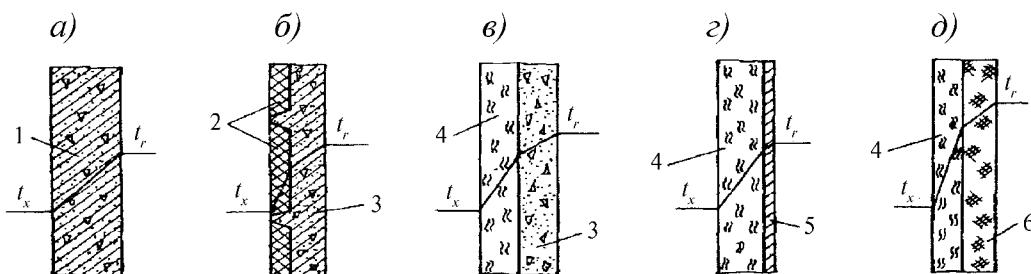
*a – однослойная; б – с теплоизоляционными вкладышами; в, г, д – двухслойная; 1 – однослоиная футеровка; 2 – плитная теплоизоляция; 3 – слой легкого жаростойкого бетона; 4 – слой теплоизоляционного материала; 5 – защитный слой тяжелого жаростойкого бетона; 6 – слой волокнистого огнеупорного материала*
