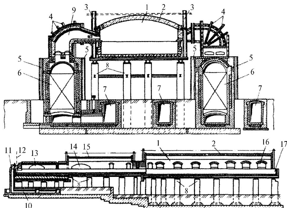
1 – рабочее пространство варочной печи; 2 – главный свод; 3 – каркас верхнего строения; 4 – каркас горелок; 5 – каркас регенераторов; 6 – регенераторная камера; 7 – воздуходымные каналы; 8 – опорные столбы; 9 – горелка; 10 – боров машинного канала; 11 – вертикальный дымовой канал; 12 – ось машины для вытягивания стекла; 13, 14 – малый и большой поперечные каналы; 15 – свод студочной части; 16 – влеты горелок; 17 – засыпной карман
