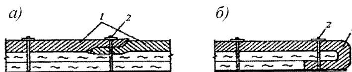
*а – на плоской поверхности; б – на торцовом участке; 1 – соединяемые слои; 2 – анкер*
