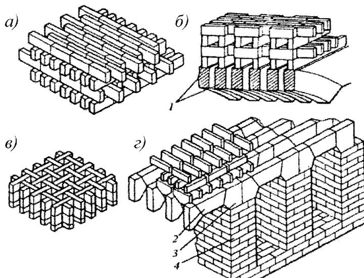
a, б – с открытymi каналами; в – с закрытыми каналами; г – фрагмент поднасадочного устройства; 1 – поднасадочная арка; 2 – распорное изделие; 3 – пята; 4 – поднасадочная стена
