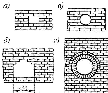
а – напуском кирпичей; б – напуском ступенями; в – натесом по шаблону; г – кольцевой полуциркульной аркой
