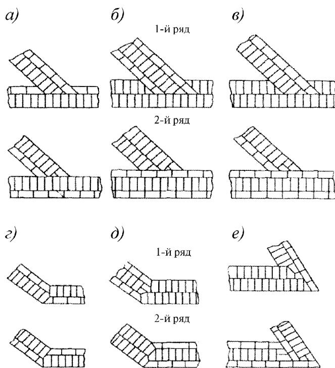
Рисунок 5 – Перевязка швов при пересечении стен под косым углом (а, б, в),
