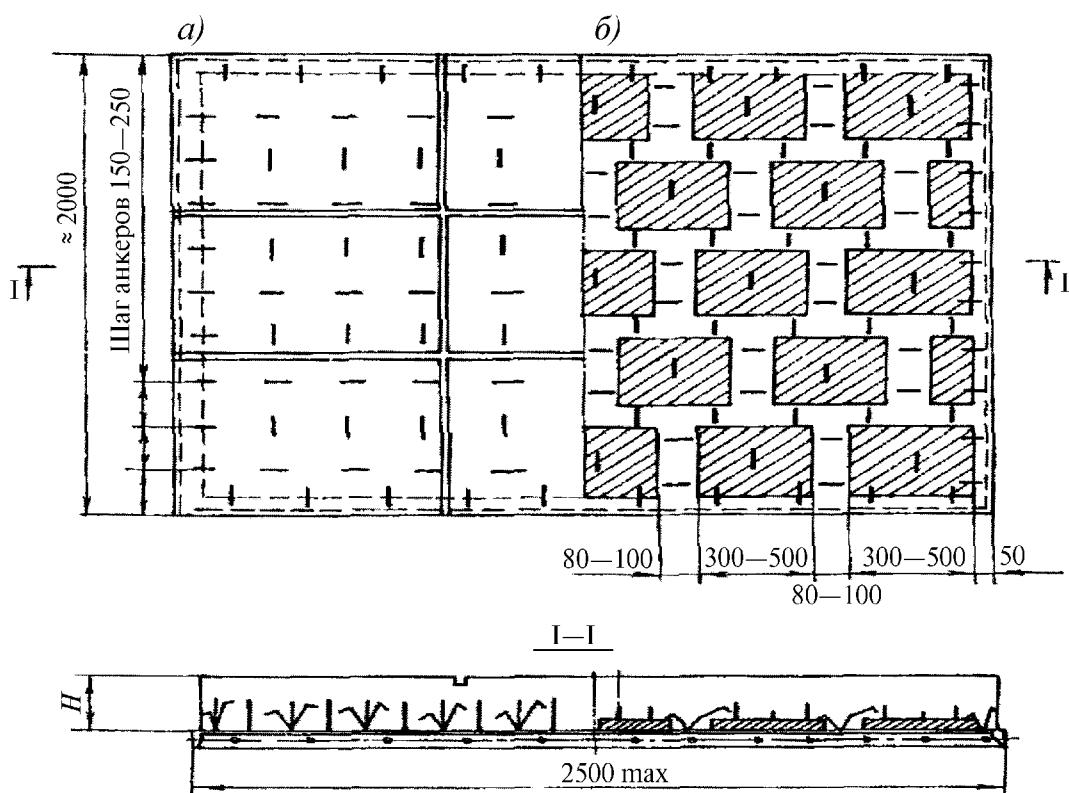
*а – однослойная; б – с теплоизоляционными вкладышами*
