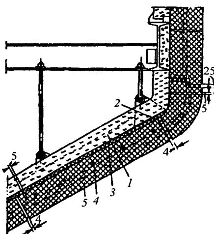
1 – диатомитовый кирпич; 2 – фанера толщиной 4 мм; 3 – уплотнительная огнестойкая обмазка; 4 – проволочная арматура диаметром 4 мм; 5 – огнеупорный шамотный бетон
