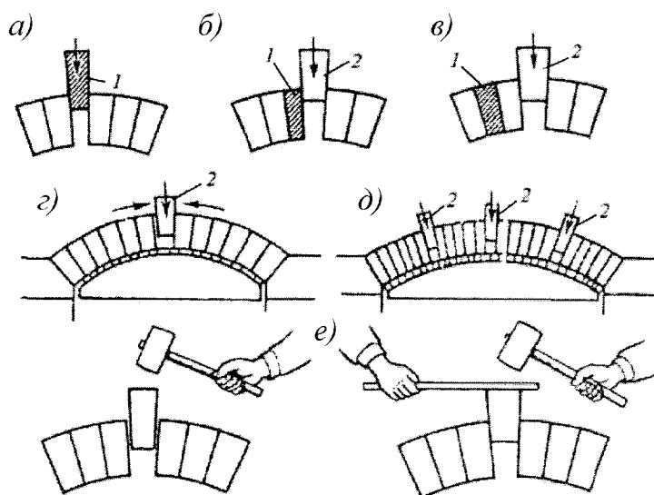
*a, б – неправильно; в – правильно; г – малый пролет; д – пролет шириной более 3 м; е – забивка замка; 1 – тёсаные изделия; 2 – замок*
